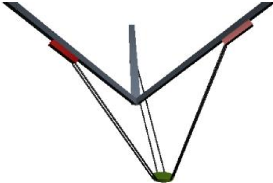
图 7.20 三角架 Delta 机器人机械结构示意图
